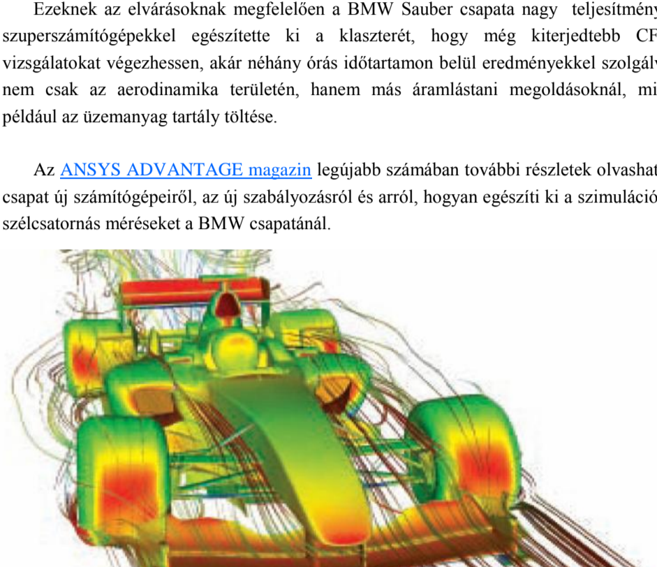
Áramvonalak az autó körül (Kép az ANSYS Advantage magazinból)
